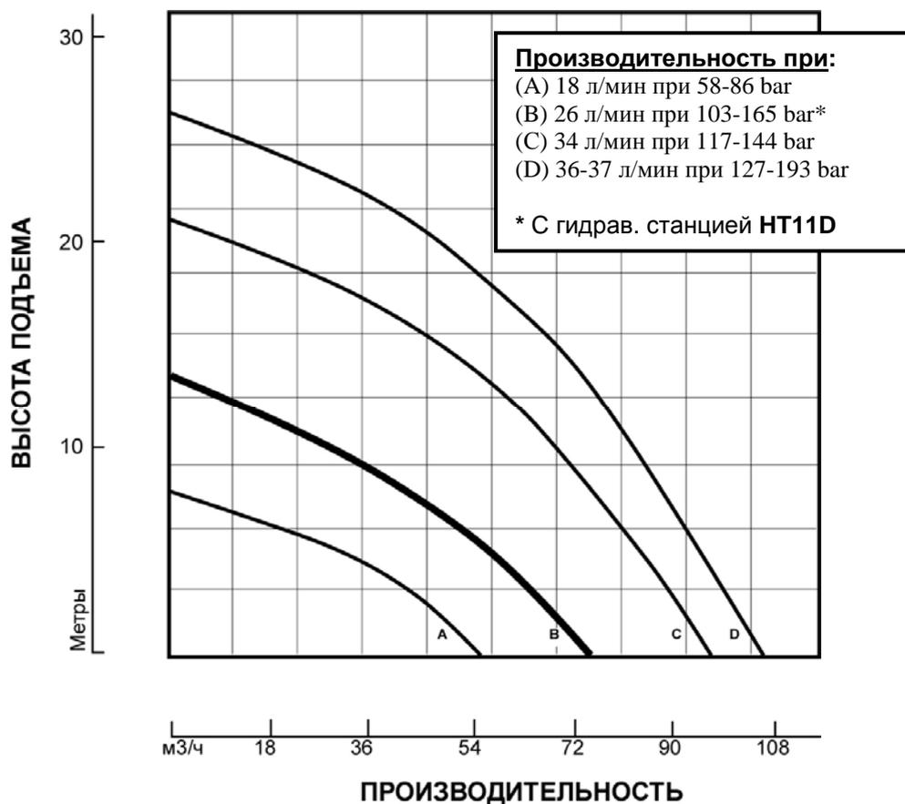
Графики основываются на испытаниях. Перекачиваемая среда - воды, температура - 15,5 С
