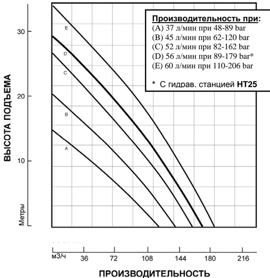
Графики основываются на испытаниях. Перекачиваемая среда - воды, температура - 15,5 С
